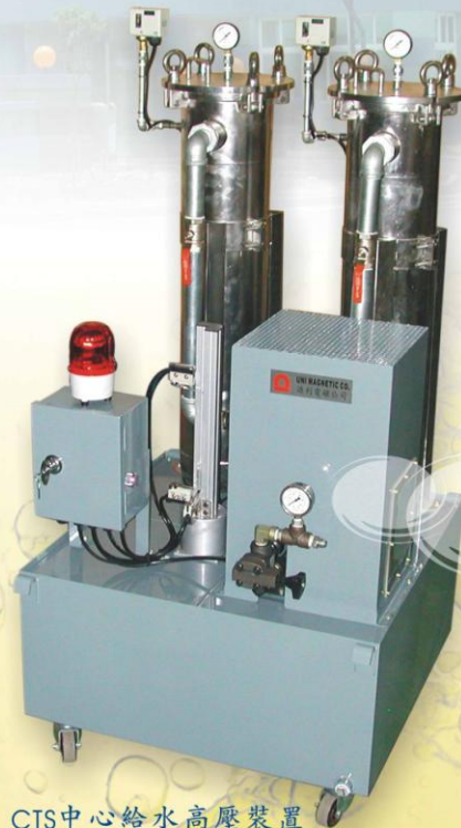
CTS中心給水高壓裝置 BF830-CTS-70BAR 壓力高達70kg/cm 2
