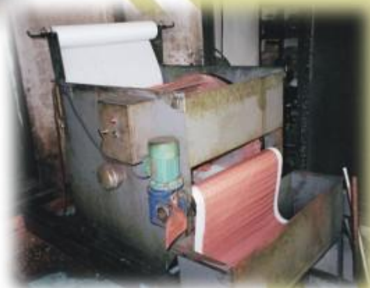
DF-500 機 械：銅線伸線機 冷卻液：水溶性伸線液
